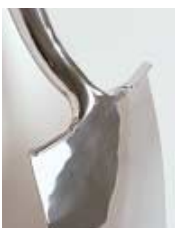
Umgebildete oder aufgesetzte Tritte sollten bei Spaten nicht fehlen, sie schonen die Schuhe
