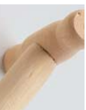
Das billigste Werkzeug – eine Spatenabel ohne Herstellerbezeichnung – war schlecht verarbeitet
