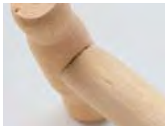
Das billigste Werkzeug – eine Spatengabel ohne Herstellerbezeichnung – war schlecht verarbeitet
