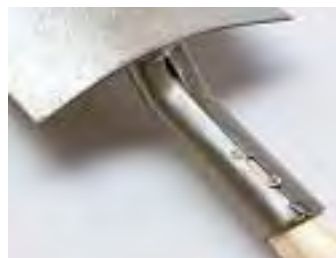
Haltbar genug, aber ebenfalls nicht schön ist diese Tülle, zu finden am Meister- und am ADW-Spaten
