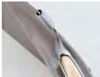
Auch die Stahlspaten der Markenanbieter waren hochwertig verschweißt und nachbearbeitet
