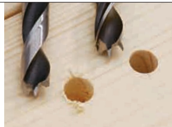
Die Holzbohrer arbeiteten unterschiedlich gut. Links ein ausreichendes Ergebnis, rechts ein ideales Loch
