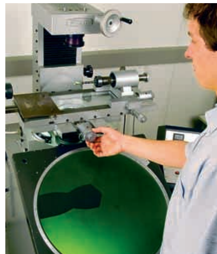
Mit Hilfe eines Profilprojektors beurteilt die VPA, ob ein Bohrer rund läuft und tatsächlich den angegebenen Bohrerdurchmesser aufweist
