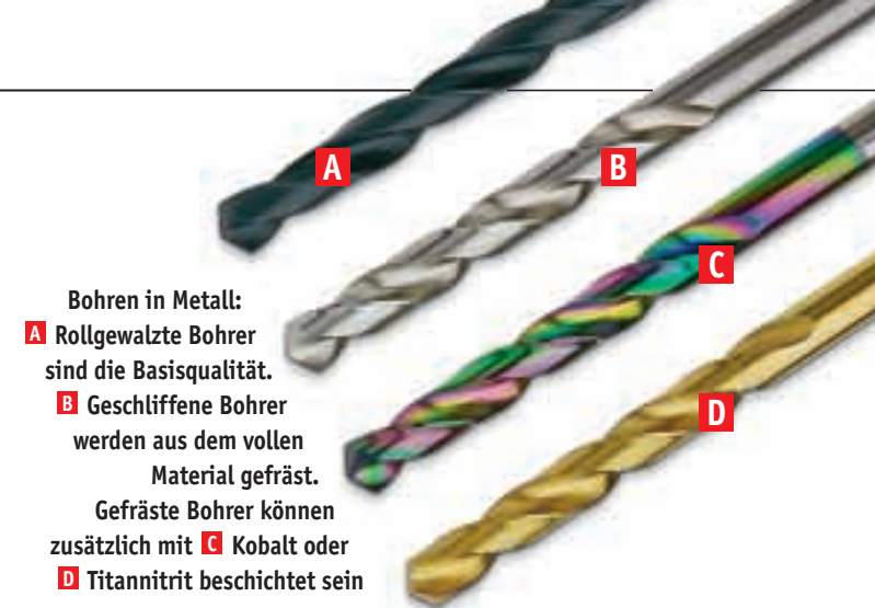
Für unseren Test wurden bei der Versuchs- und Prüfanstalt (VPA) allein in Metall über 1000 Löcher gebohrt – unter idealen Bedingungen. Am besten bohrt man Metall mit einer stationär geführten Maschine und steter Kühlmittelzugabe. Bei großen Durchmessern zunächst kleiner vorbohren
