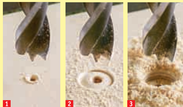
1 Zuerst sorgt die Zentrierspitze für mittigen Halt, dann schneiden die Außenseiten des Bohrers die Späne ab. Erst dann entsteht das Loch
