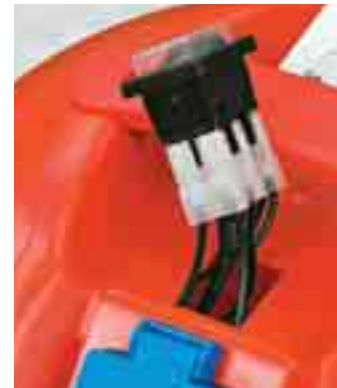
Sicherheitsrisiko: Einige Schalter sind leicht aus dem Gehäuse zu ziehen
