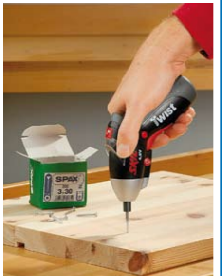
Unbequem ist ein zu großer Winkel: Die Führung der Werkzeugspitze ist ungenauer, außerdem muss das Handgelenk je nach Schraubposition stark angewinkelt werden
