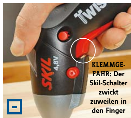
KLEMMGEFAHR: Der Skil-Schalter zwickt zuweilen in den Finger
