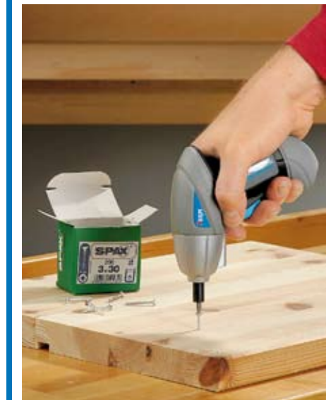
Gute Kontrolle ermöglicht ein fast senkrecht zur Motorachse abgewinkelter Griff. So wird auch eine recht große Andruckkraft gut auf die Schraubstelle übertragen
