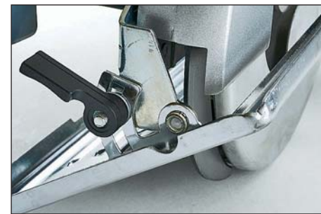
Bei preiswerten Maschinen wird an der Materialstärke des Auflagetisches gespart – dann ist das Gerät insgesamt instabil und lässt sich nicht gut führen
