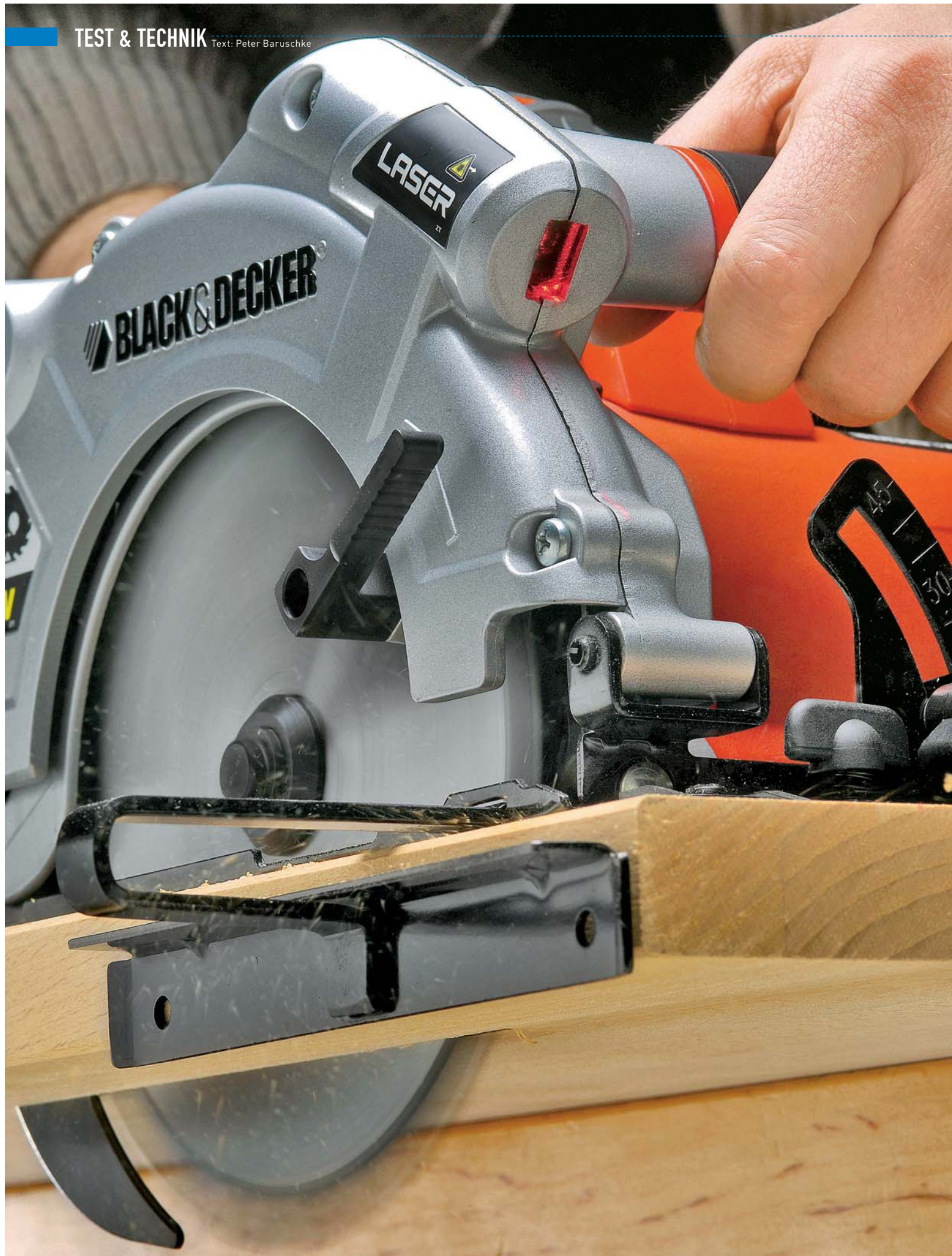
Fotos: Anne Stefanie Schade, Claudio Kalax, Pavel Strnad Zwei Maschinen haben serienmäßig einen Laser an Bord – hilfreich bei Schnitten ohne Anschlag
