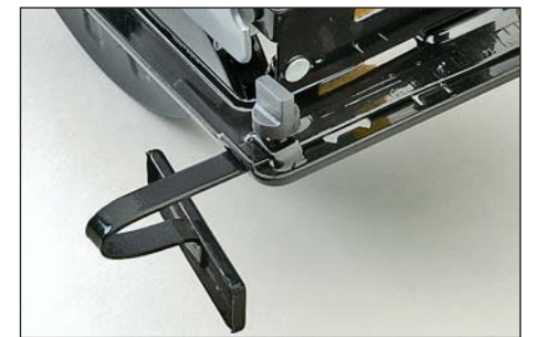
Der Parallelanschlag von Brüder Mannesmann wird schon bei normaler Handhabung verbogen – am besten wegwerfen und mit einer Latte als Führung arbeiten
