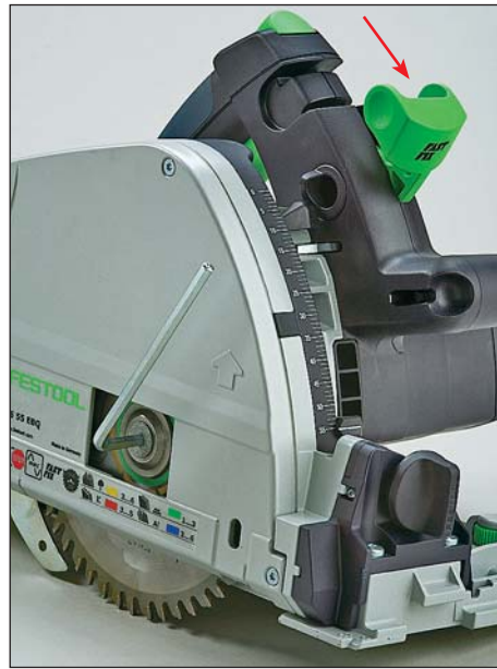
Ausgeklügelt ist der Sägeblattwechsel bei Festool: Ein Klappschalter hält die Tauchsäge in der optimalen Tiefenposition und blockiert die Motorwelle
