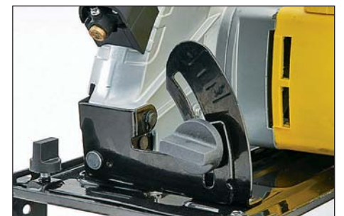
Zwar ist hier die Gehrungsverstellung gut zu bedienen, nur leider kann man auf der Skala nicht erkennen, welcher Winkel eingestellt ist (Brüder Mannesmann)
