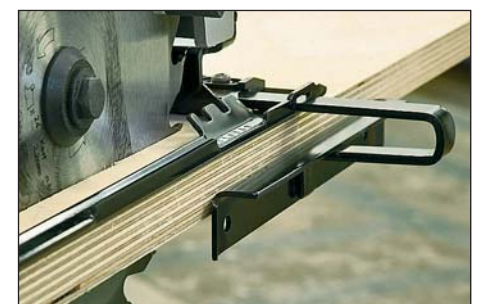
An dünnem Material kann die Säge mit einem nach unten versetzt angebrachten Parallelanschlag nicht geführt werden – bei Black & Decker und DeWalt
