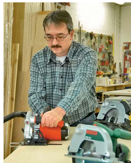
Mit allen Sägen können Gehrungsschnitte präzise ausgeführt werden, nicht immer ist die Einstellung so einfach einstell- und ablesbar wie hier bei Bosch
