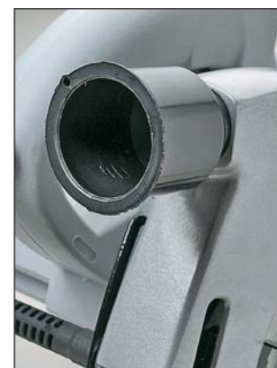
Funktioniert zwar, ist aber ungünstig geformt: Staubsaugeradapter bei Go On
