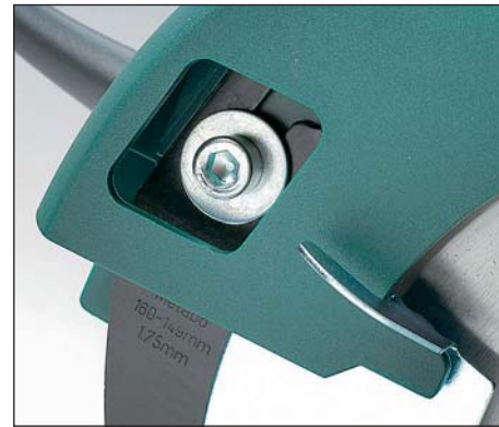
Sicher: Bei Metabo ist die Stellschraube für den Spaltkeil gut erreichbar – das lädt dazu ein, dessen Position auch tatsächlich richtig anzupassen
