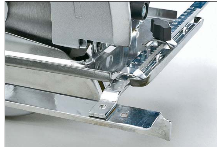
Labil und etwas mühsam einzustellen: Der Parallelanschlag ist meist eine der Schwachstellen an Billigsägen (Alpha Tools)
