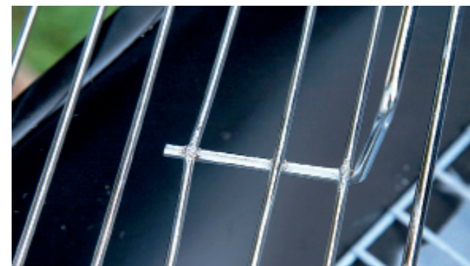
BILLIG: Am Barbecue -Modell von BBQ wurde der Grillrost schlampig geschweißt. Die Griffe verkleinern das Grillfeld.
