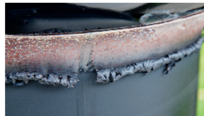
VERBRANNT: Beim Landmann -Grill verbrennt am Zugkamin die Farbe – das lässt dem Rost leichtes Spiel.
