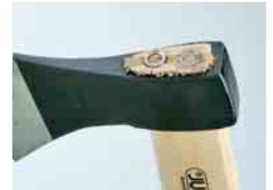
Die Juco-Axt ist zwar doppelt gesichert – doch dem Abziehtest nach DIN hielt sie bei weitem nicht stand
