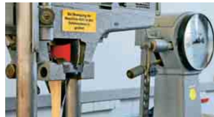
Mit einer Zerreißmaschine wurde die Kraft ermittelt, bei der sich der Axtkopf vom Stiel abziehen lässt. Nur ein Werkzeug versagte in dieser wichtigen Disziplin
