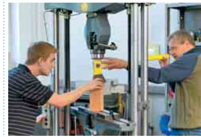
Mit diesem Prüfaufbau wurde bei der VPA die Kraft gemessen, die Axtschneiden zum Spalten von Holzscheiten benötigen – wir nutzten Hartholz-Pfahlabsschnitte
