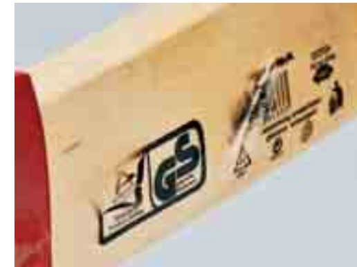
Unzulässig: Herstellerkennzeichnungen und Prüfzeichen dürfen nicht auf abziehbaren Aufklebern gedruckt sein
