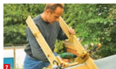
7 Oben verbinden Sie die mit Zwingen fixierten Wangen und Holme mit 4-x-40-mm-Schrauben
