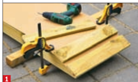
1 Die Rutschenwangen sind unten im 80-cm-Radius gerundet. Rutschfläche auflegen und mit ...
