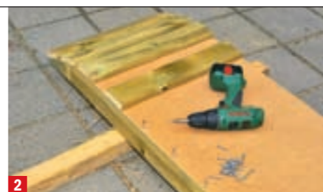
2 ... vier Querbrettern verschrauben. Die restliche Rutschfläche mit 4-x-40-mm-Schrauben fixieren
