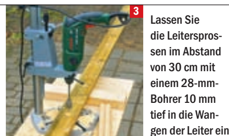
3 Lassen Sie die Leitersprossen im Abstand von 30 cm mit einem 28-mm-Bohrer 10 mm tief in die Wangen der Leiter ein
