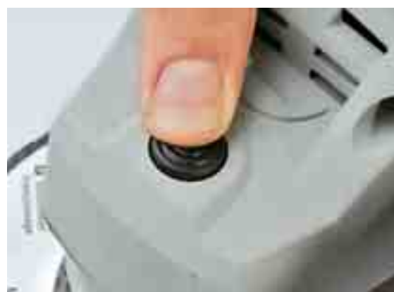
Alle getesteten Maschinen haben eine werkzeuglose Spindelarrretierung für den Scheibenwechsel
