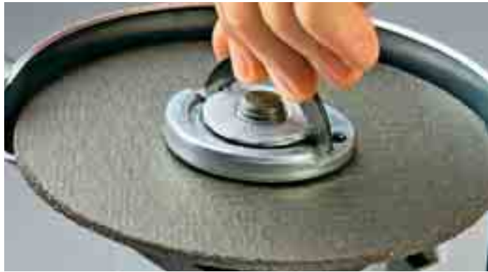
Bei einigen Maschinen kann die Scheibe völlig werkzeuglos gewechselt werden – viele Hersteller bieten entsprechende Haltemuttern als Zubehör an
