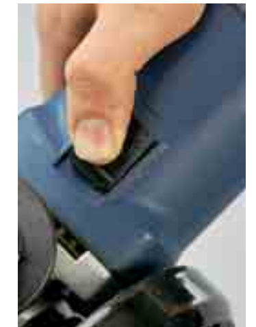
Sehr schwergängig beim Einschalten: Schiebeschalter am Ferm-Gerät
