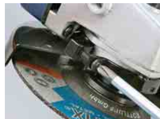
Beim Gerät von Budget kann die Schutzhaube nur mit Werkzeug verstellt werden
