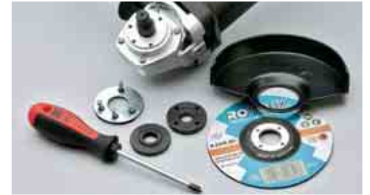
Beim Ferm-Gerät muss vor der ersten Anwendung die Schutzhaube umständlich montiert werden, dafür benötigt man einen Schraubendreher
