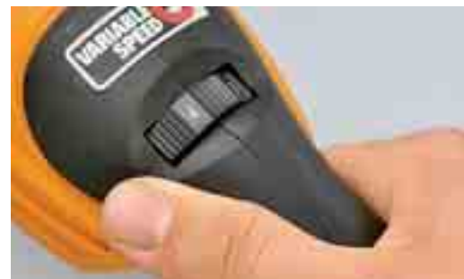
Mit einer Drehzahlvorwahl (hier bei Worx) erweitert sich der Anwendungsbereich eines Winkelschleifers bis hin zum Polieren
