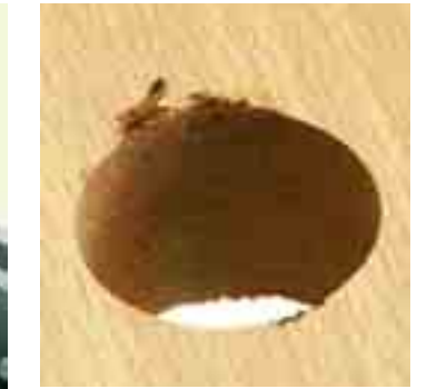
Unschön: Oberflächendefekte an der Tischplatte beim Tisch von Work Plus
