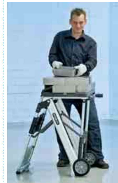
Die Versuchs- und Prüfanstalt (VPA) in Remscheid überprüfte mit Metallblöcken die angegebene Belastbarkeit der Tische
