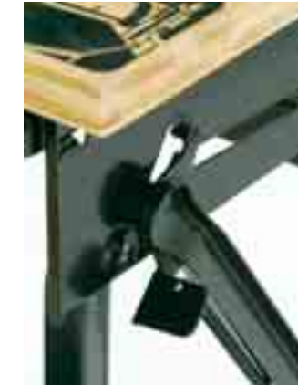
Schwergängig: Spannbacken bei Stanley
