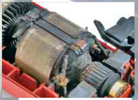
Diese Billigmaschine brannte im Dauertest regelrecht aus, die Gehäuseschale begann zu schmelzen
