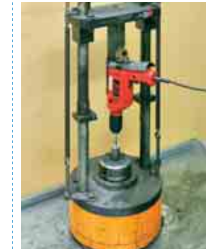
Härteprüfung: Der Dauertest beim TÜV
