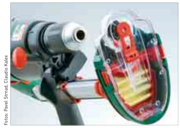
Das Gerät von Bosch bietet als einziges im Test eine serienmäßig montierte Staubabsaugung
