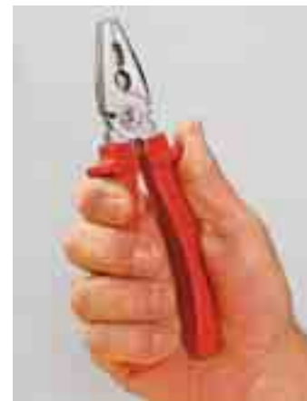
Ergonomisch ungünstig sind solche stark ausgeformten Griffabschlüsse
