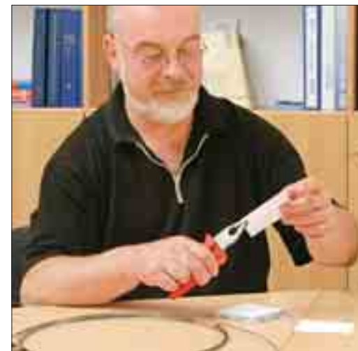
Die Halteprüfung an Kombizangen mit Papier gibt einen Hinweis auf die Passung der Zangenbacken
