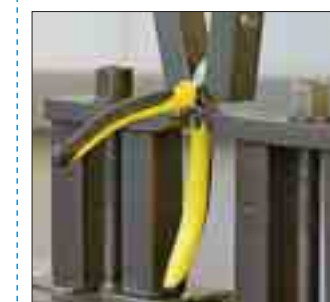
Beim Zugversuch wird die Verbindung zwischen Werkzeug und Griff belastet
