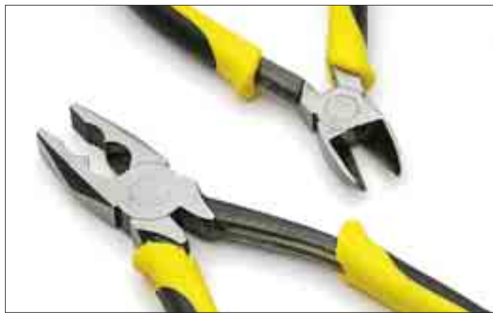
Schwachpunkt bei Stanley: Die Griffe sind zu leicht abziehbar. Statt der geforderten 750N hielt die Verklebung nur bis höchstens 420N stand
