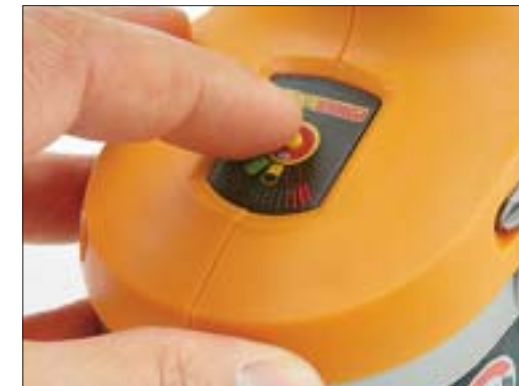
Bei üblichen NiCd-Akkus ist eine Kapazitätsanzeige nicht sinnvoll, da der Füllstand nicht verlässlich angezeigt wird
