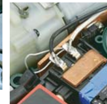
Der Konstruktions-Check deckt verborgene Schwächen auf – hier die nur einfach aufgelöteten Schalterkontakte bei Metabo
