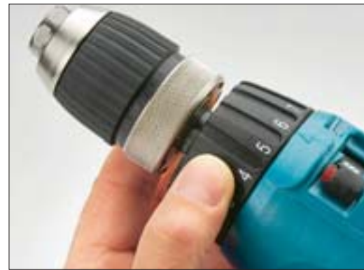
Eine differenzierte Wahl des Drehmoments ist bei fast allen Maschinen Standard. Die Bedienung fällt leicht
