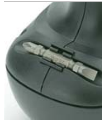
Teilweise sind am Gehäuse verwahrte Bits schwer wieder entnehmbar
