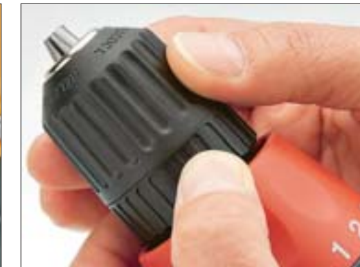
Die Bedienung des Bohrfutters ist bei einigen Maschinen umständlich – von Vorteil ist ein automatischer Spindelstopp
