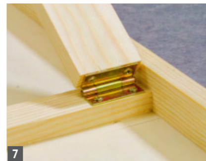
7 Befestigen Sie die Zwischenstützen des mittleren Wandrahmens mit Scharnieren an der oberen Dachquerleiste
