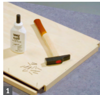
1 Klinken Sie zunächst die Ecken der Böden aus. Dann die Leisten unterleimen und mit Nägelchen fixieren
