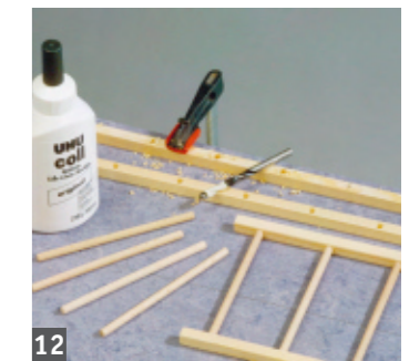
12 Mit etwas Kreppband als Tiefenanschlag Löcher für die Geländerstäbe bohren und diese einleimen
