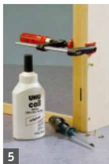
5 Wandrahmen an die Rückwand leimen und mit Schrauben fixieren
