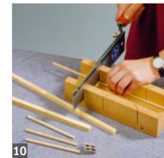
10 Längen Sie die Terrassengeländerstäbe und die Querleisten ab. Stäbe an beiden Enden leicht anspitzen
