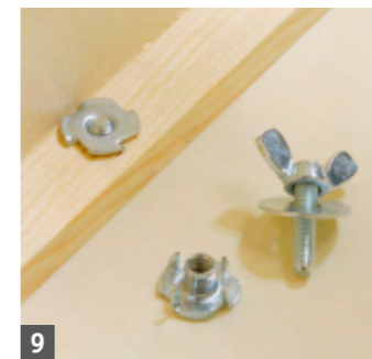
9 Die Rückwand mit Flügelmuttern von hinten mit der hinteren Bodenleiste verschrauben
