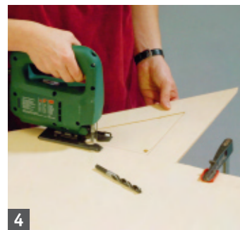
4 Die Rückwand ausschneiden. In dem aufgezeichneten Fensterdreieck für das Sägeblatt ein Loch bohren
