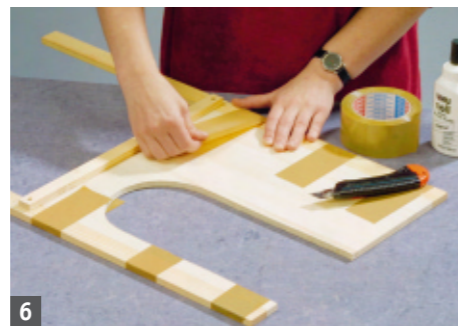
6 Die obere Zwischenwand mit Leim in den mittleren Wandrahmen einsetzen und bis zum Abbinden mit Paketband fixieren
