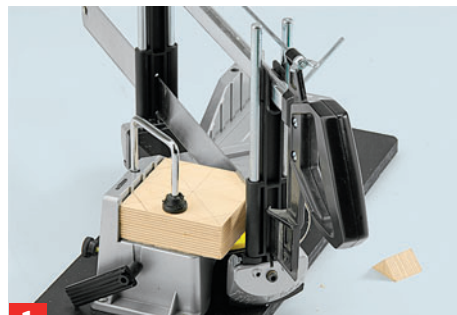
1 Die achteckige Nabe aus aufgedoppeltem Multiplex wird auf der Gehrungssäge zugeschnitten
