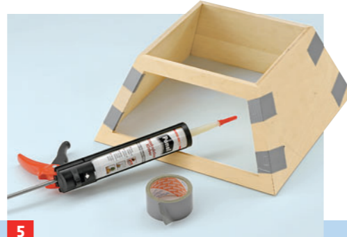
5 ... untere Schnittkante ist wieder um 10° angeschrägt. D4-Klebstoff (wasserfest) auf die Schnittkanten auftragen und ...
