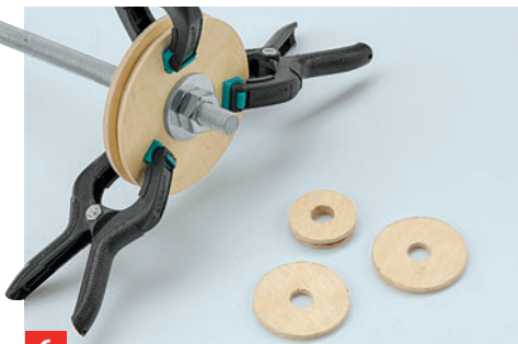
6 Die Scheiben auf einer M10er Gewindestange zentriert miteinander verleimen
