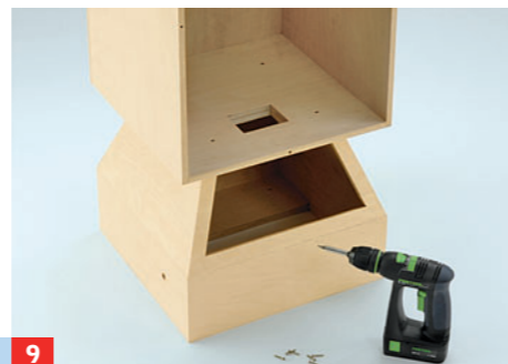
9 Bevor Sie die Front aufleimen, schrauben Sie den Hauptbaukörper auf den Pyramidenstumpf. Achten Sie darauf, ...
