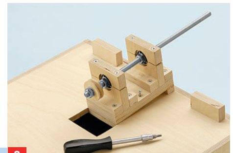
8 Kopfeinheit auf den Deckel des Hauptbaukörpers montieren, Wassereinheit auf den Boden des unteren Kastens schrauben
