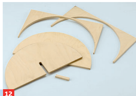
12 Front und Rückwand der Haube ausschneiden. Die Front (mit Schlitz für die Antriebswelle) ist um 5° nach hinten ...
