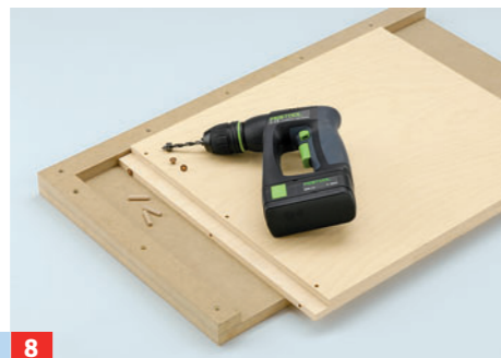
8 Die Platten des Hauptbaukörpers werden verdübelt. Die Dübellöcher mit Markierstiften (Dübellfixen) übertragen
